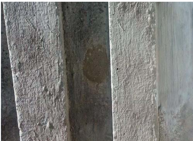
Näiteid sobiva parandusmördi otsinguist. Kumbki katsetest ei sobi. Foto: T. Tiidor
