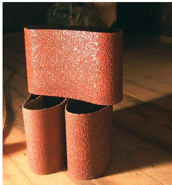
Liivapaperit valides tuleks alustada karedamast ja lõpetada peeneteralistega. Foto: Säästvad Ehituslahendused
