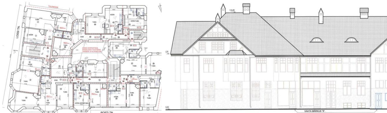
Joonis 3 Esmase energiaarvutuse jaoks kasutatud hoone geomeetria (vasakul). Avatäidete osakaal fassaadi pindalast ning hoone kõrgus (paremal).
